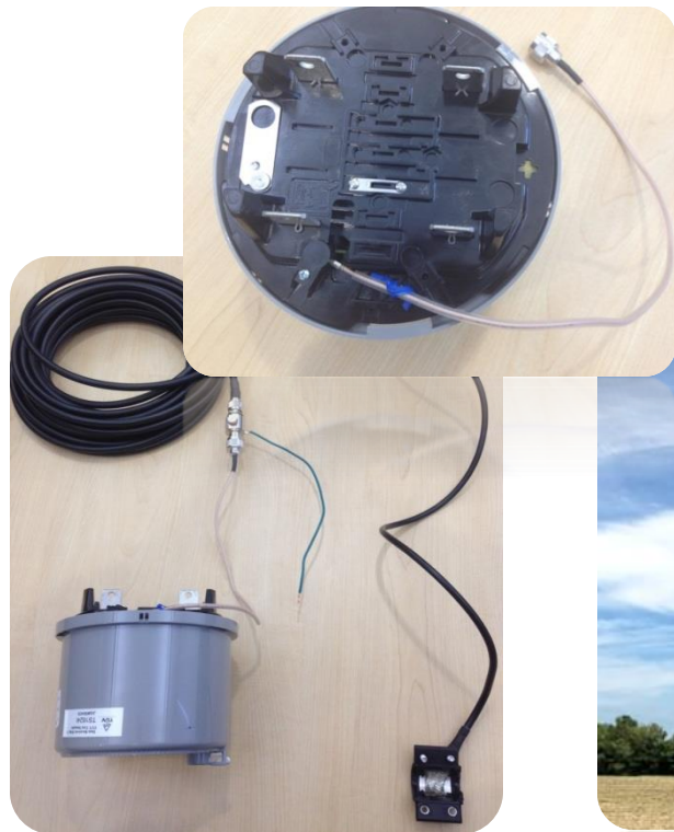
External Meter Antenna
